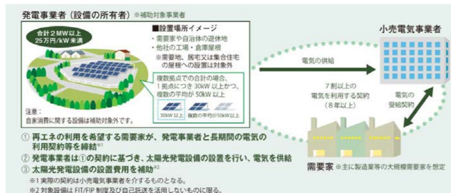
補助事業スキーム図 (補助元のJPEA太陽光発電推進センターサイトより転載)
